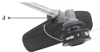
Fig. 10 – Montaje de la protección
