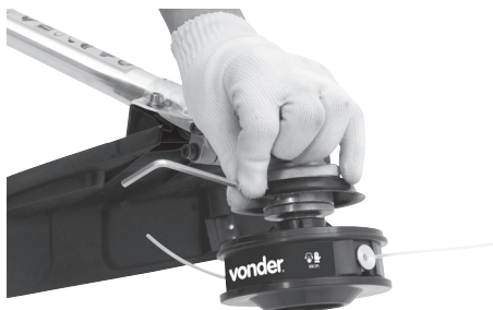
Fig. 18 – Instalando el carrete de nylon
