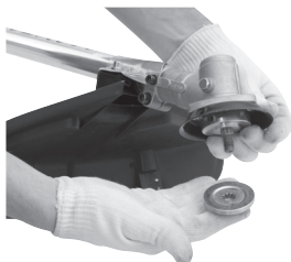
Figura 15 – Montagem da flange externa
