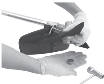
Figura 13 – Finalizando a montagem da lâmina
