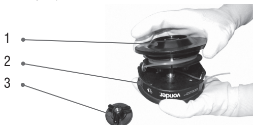
Fig. 19 – Abriendo el carrete de nylon
