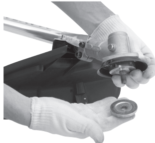
Fig. 17 – Montaje de la brida externa
