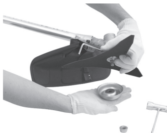
Figura 12 – Colocando a flange externa
