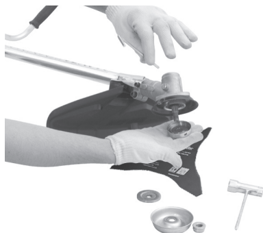
Figura 10 – Montagem da flange interna
