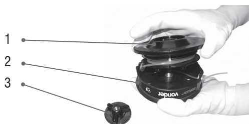
Figura 17 – Abrindo o carretel de nylon
